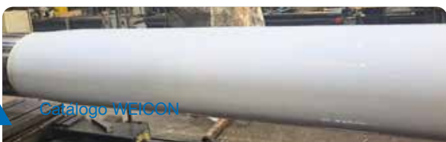
Revestimiento de ejes de hélice y palas | WEICON WL
